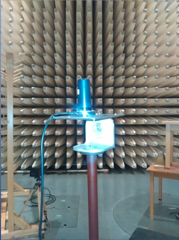
Všesmerová anténa kalibrovaná v pásme 700 MHz – 3,7 GHz
