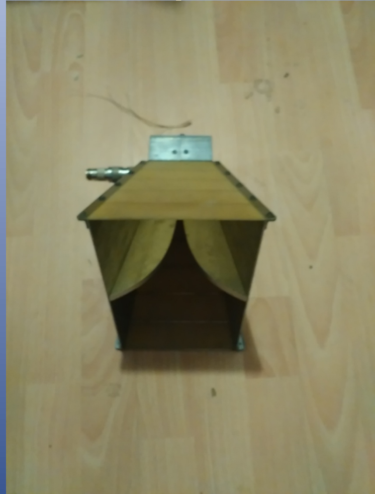
Smerová anténa – horn pre pásmo 1 -18 GHz
